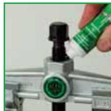
Wir empfehlen die Verwendung von KUKKO Spezialfett für Druckspindeln (Art.-No.: 699999) oder von KUKKO Bio-Multi-Öl (Art.-No.: 699990).
